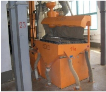
Рис. 6. Пневматичні сортувальні столи для сортування насіння за питомою масою
