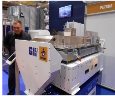
Рис. 6. Пневматичні сортувальні столи для сортування насіння за питомою масою
