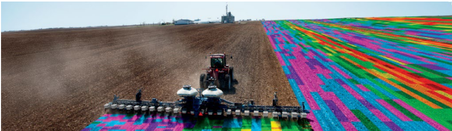
Рис. 10. Строкатість щільності ґрунту, що призводить до неоднорідності глибини заробляння насіння
