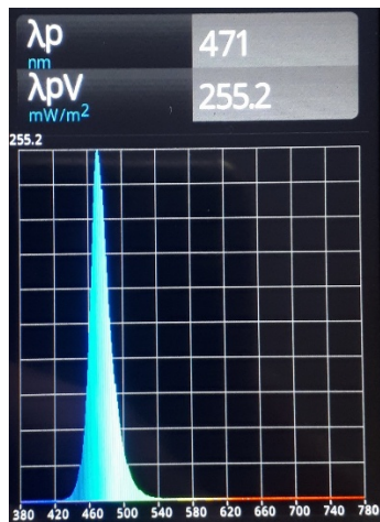
Рис. 6. Спектр опромінення синім світлодіодом рослин буряків цукрових приладом FLS 10s
