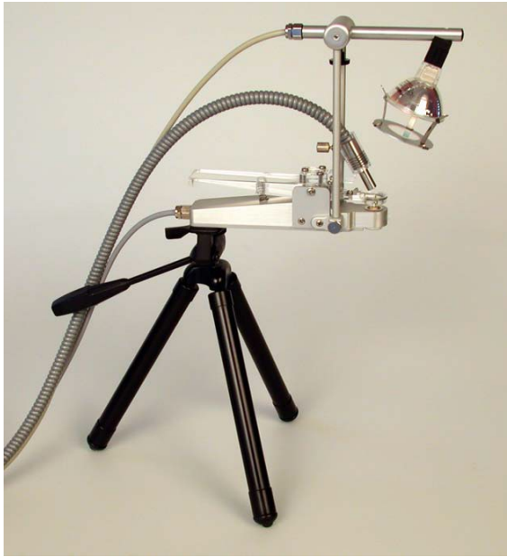
Рис. 3. Визначення флуоресценції фотосистеми на дрібних листках рослин із заміною синього світлодіода на галогенну лампу
