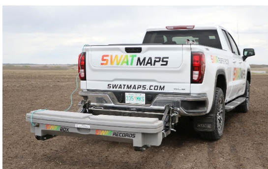
Рис. 3.7. Пристрій для неруйнівного визначення якості ґрунту (а) та приклад електронної карти (б) вологості ґрунту [20]
