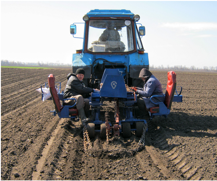
Рис. 3. Садіння міскантусу гігантського на дослідному полі ІВКіЦБ (с. Ксаверівка друга) дворядною машиною СМ-2 (розробка відділу технологій вирощування біоенергетичних культур)
