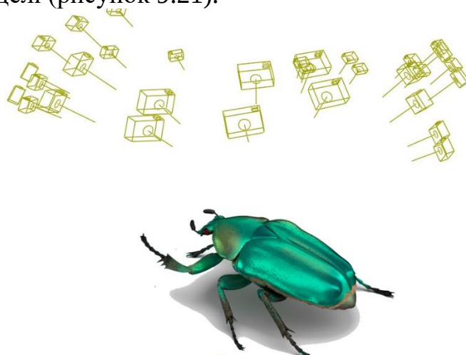
Рисунок 9.21. Сканування 3D-об'єктів без використання надрукованих калібрувальних маркерів
