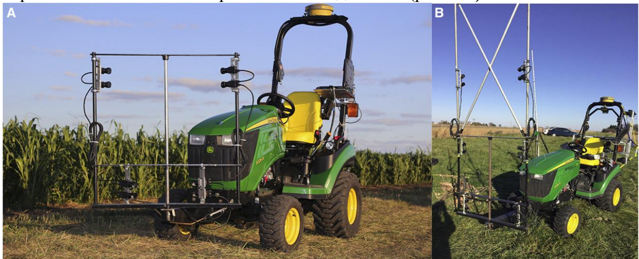
Рис. 9.2. Надземні транспортні засоби для фенотипування на базі тракторів або інших стандартних шасі
