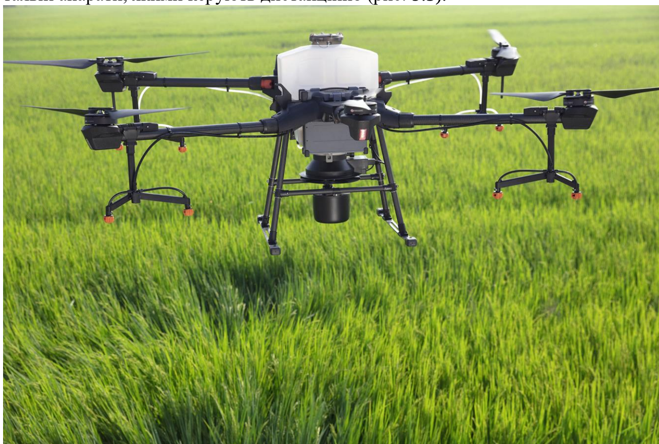
Рис. 9.5. БПЛА квадрокоптер Agras T20 з пристроями для фенотипування та устаткуванням для внесення агрохімікатів і 8-ма форсунками
