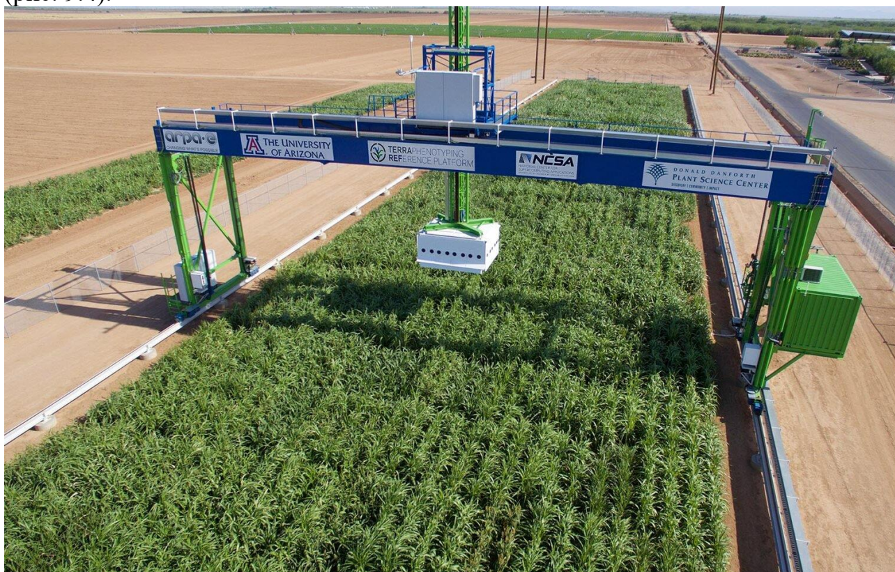
Рис. 9.4. Робот для фенотипування рослин Field Scanalyzer
