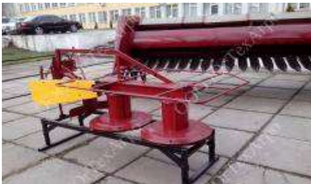
Рис. 2.31. Косарка роторна КР-1,65, призначена для скошування верби і укладання пагонів у валок (Україна). Висота скошування – 42 мм, кількість роторів – 2, кількість ножів – 6, продуктивність – 1,6 га/год., робоча швидкість – 15 км/год.
