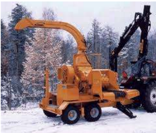
Рис. 2.45. Причіпна автономна щепорізка з власним двигуном транспортується транспортним засобом
