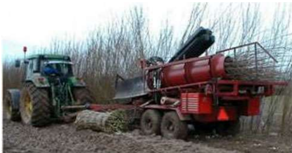
Рис. 2.41. Снопов'язувачий комбайн для збирання пагонів енергетичної верби, виробництво Швеція
