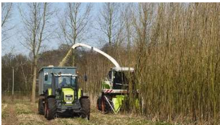
Рис. 2.35. Збирання біомаси енергетичної верби самохідним комбайном (Салікс Енерджі), 2014 р.
