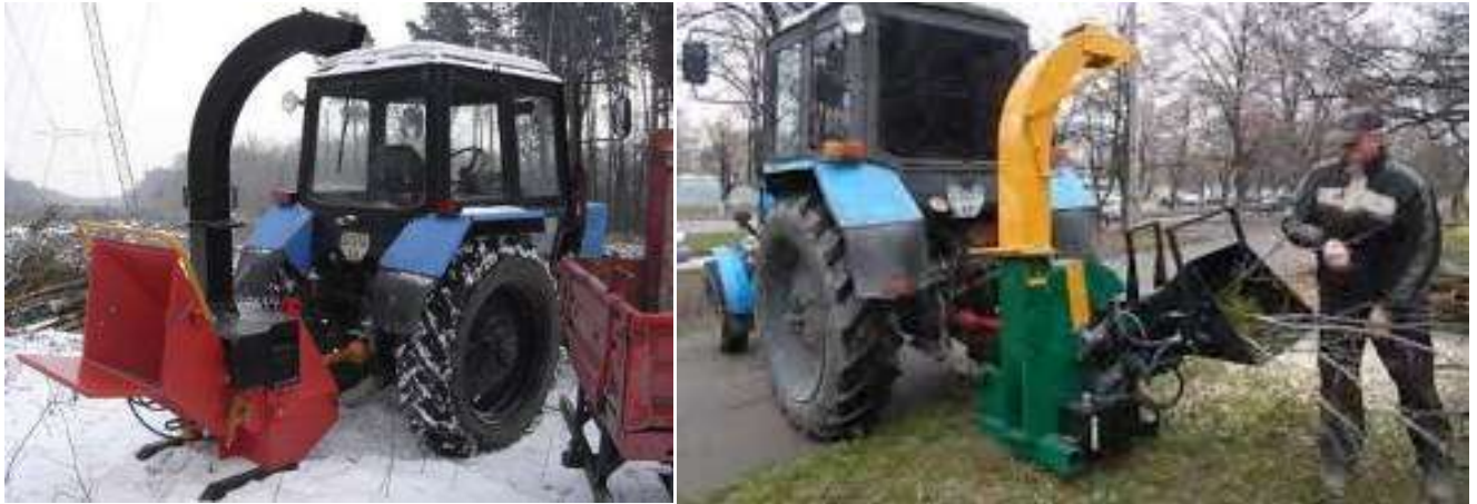
Рис. 2.43. Навісна щепорізка, що агрегатується з тракторами класу 20-30 кН, працює від валу відбору потужності трактора
