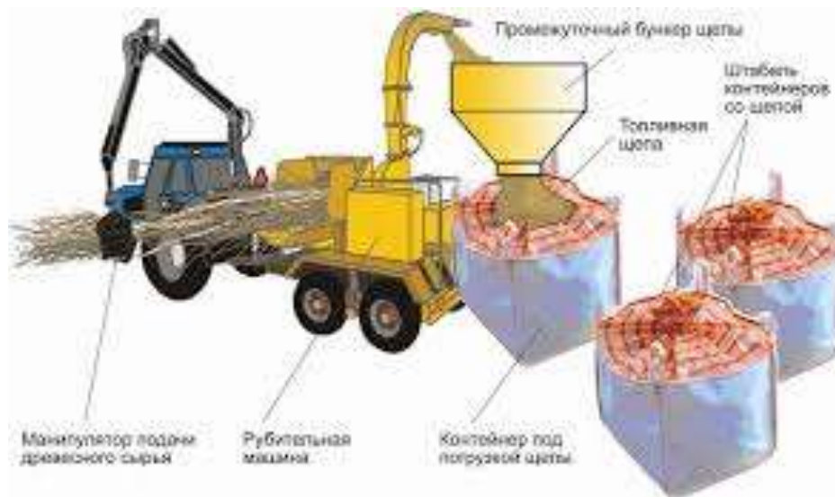
Рис. 2.42. Спеціальна машина для подрібнення деревини з встановленим у передній частині шасі маніпулятором, за допомогою якого матеріал подається в подрібнюючий орган, який прикріплений в передній або бічній частинах шасі, з бункером, або бег-бегом для тріски, встановлюваним у задній частині шасі машини.
