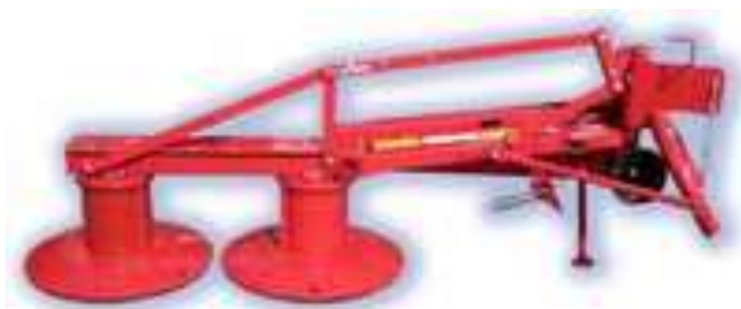
Рис. 2.30. Косарка роторна Z-169 з підсиленням карданом (Польща) для скошування верби і укладання пагонів у валок. Висота зрізування – 42 мм, кількість ножів – 6, продуктивність – 2 га/год., робоча швидкість – 15 км/год.
