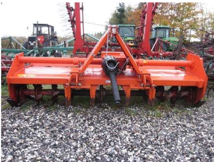
Рис. 2.27. Культиватор-фреза ORTOLAN HC250 (Італія) для розпушування ґрунту в міжряддях енергетичної верби
